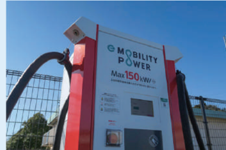
150kW対応の急速充電器の例
